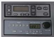
Полностью автоматизированный кондиционер воздуха и радиоприемник FM/AM
