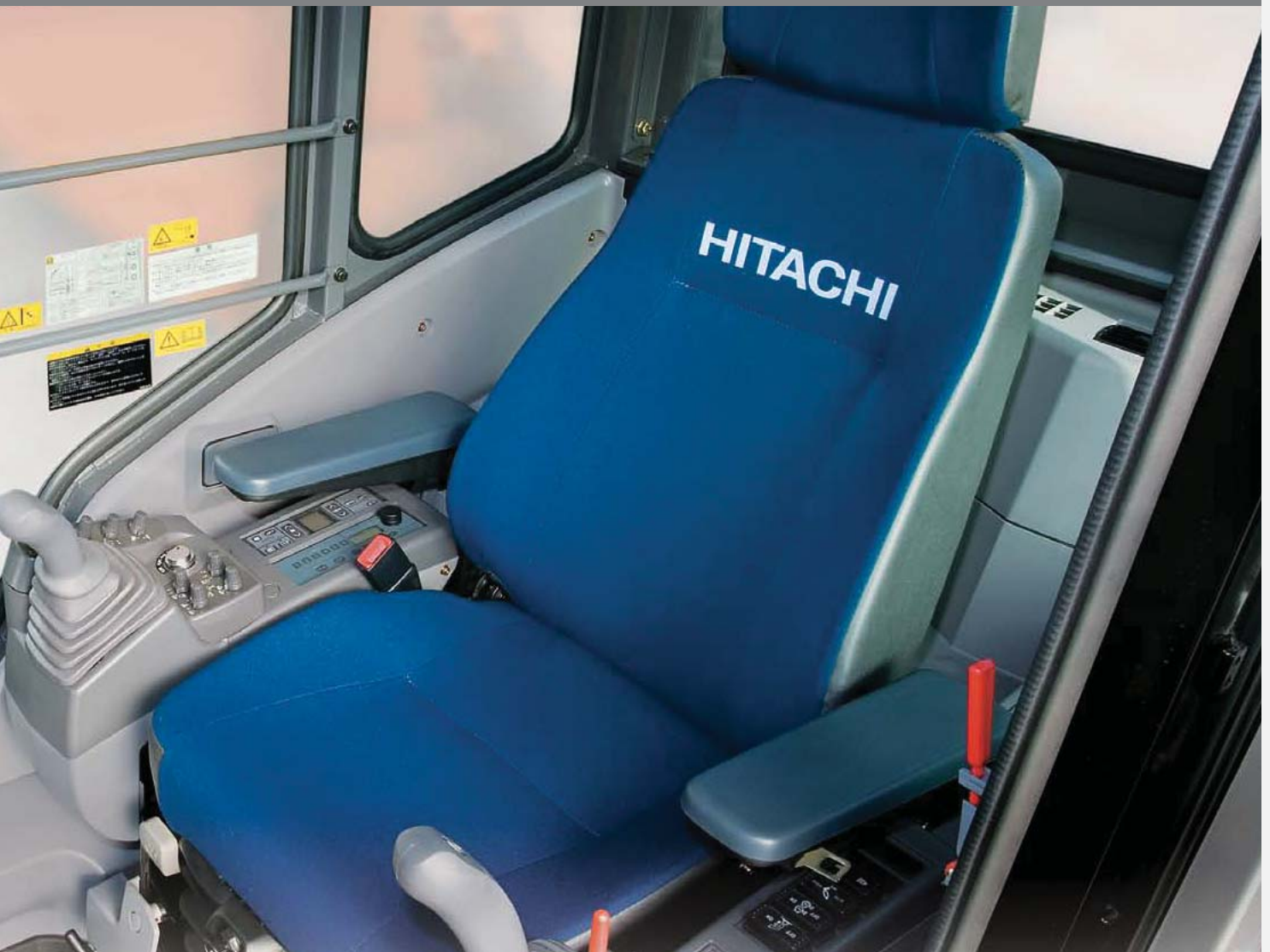
Примечания: На иллюстрации показано сиденье с пневмоподвеской и переключателями, поставляемыми по отдельному заказу.
