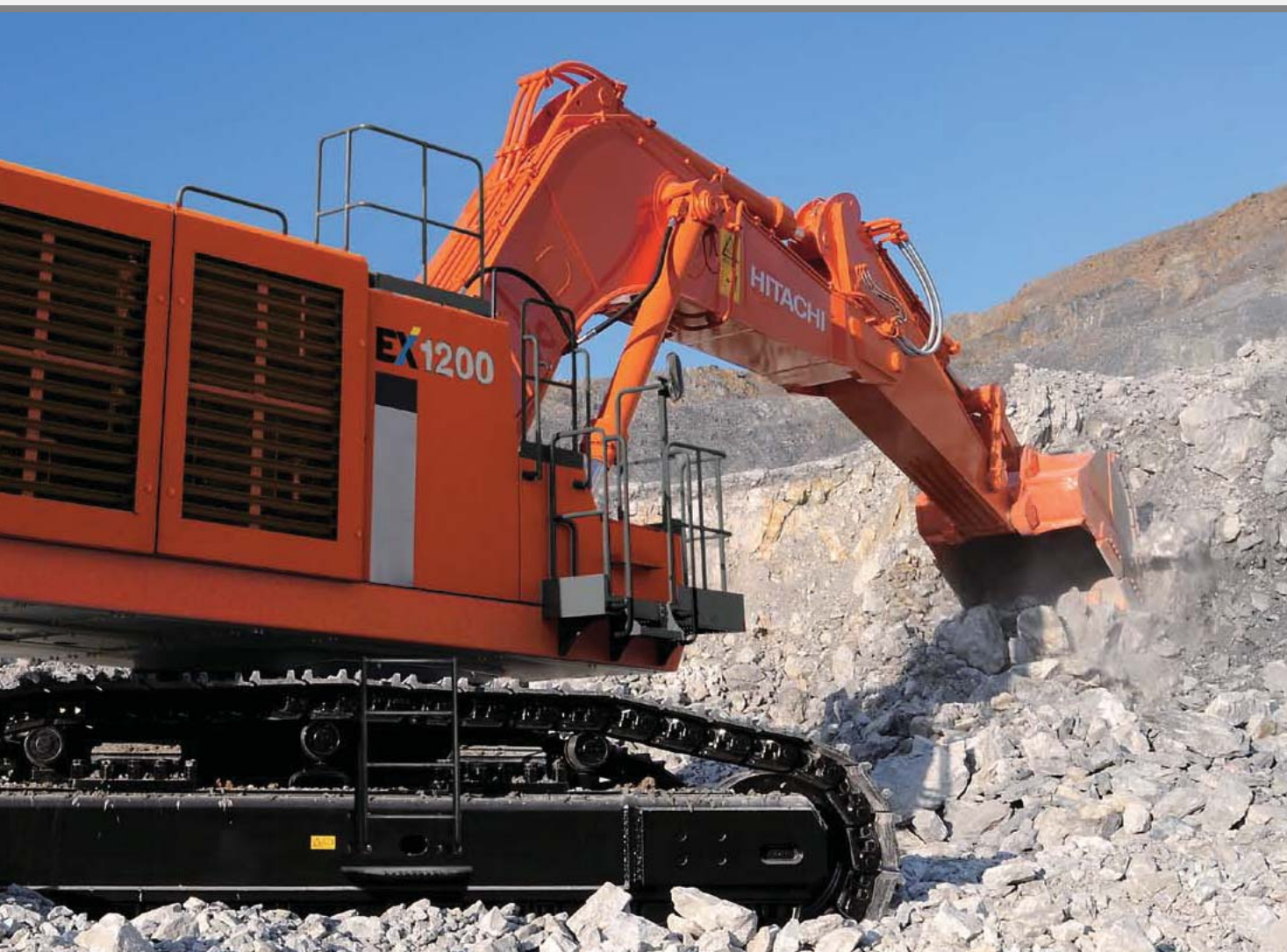
Примечание: Эта фотография включает в себя специально разработанные компоненты, в том числе усиленные пластины для боковой рамы.
